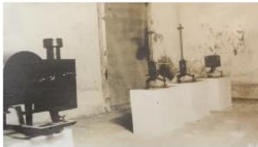
Figura 4: Magnetógrafo e variômetros utilizados por Daniel Wise. Fotografia realizada em 09 de junho de 1919. Cortesia da Carnegie Institution, Department of Terrestrial Magnetism .
